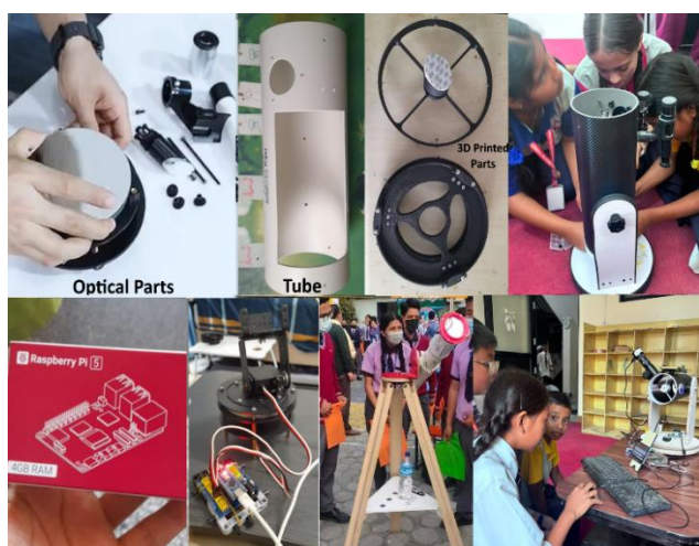
图 2 光学部件与树莓派 5 主控制器。
