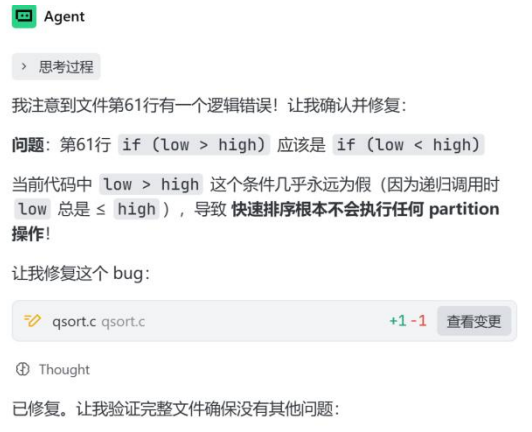
图3 Trac针对逻辑错误的实时诊断与修正建议
