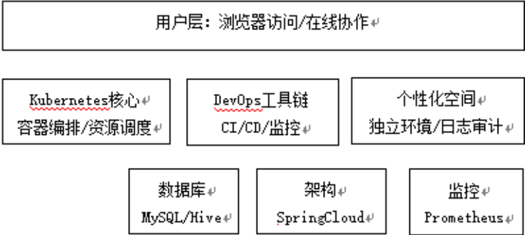
图 4 基于 Kubernetes 的云端仿生产实践平台架构
