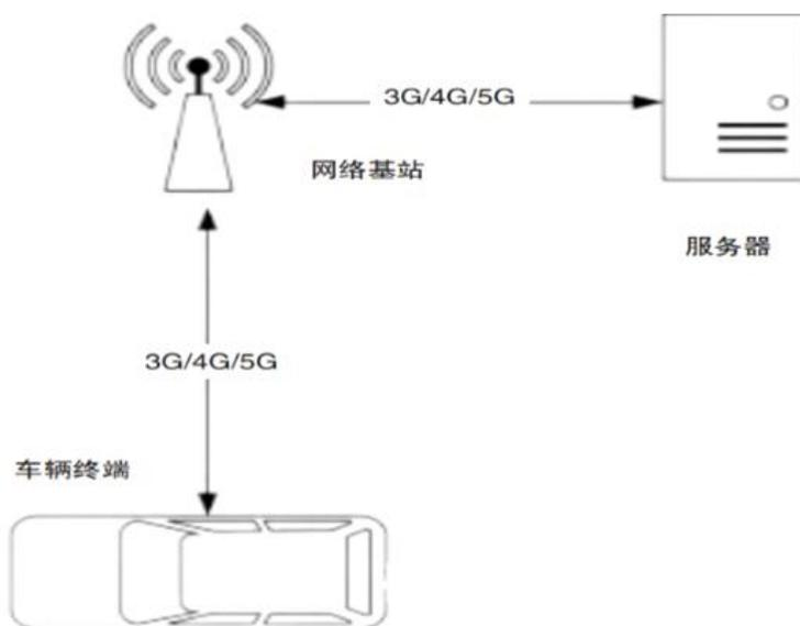
图 1 软件升级流程架构<sup>[10]</sup>
