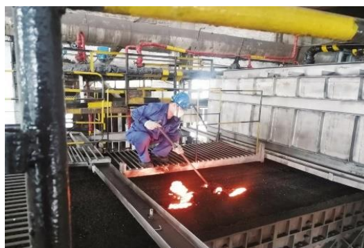
图 5 烧结点火料面人工检测方法
