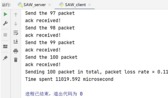
图 5 自动重传请求协议实验结果
